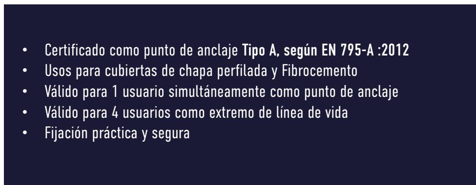
Su versatilidad permite la fijación también sobre cubiertas de **Fibrocemento**. De la misma manera que la Chapa perfilada, no es necesario el corte o la modificación de la impermeabilización de la cubierta y se suministra y con los mismos elementos. Su funcionalidad y eficacia es total en ambas opciones.
